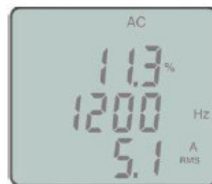
EKRAN F407 pomiar harmonicznych H3 z częstotliwością podstawową 400 Hz
